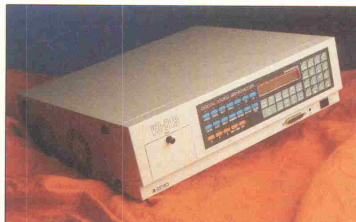
Bild 7. 240 MHz- 'Testbild- quelle' – der Videosignal- generator VG 819.
